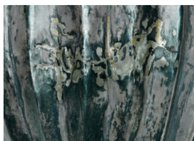
Abb. 8: Silberner Rippenbecher (MVF Xlc 5104). Detail der modernen Verlötung mit grober Überarbeitung durch Feilen oder Schleifen. © SMB, MVF Foto: Hermann Born
