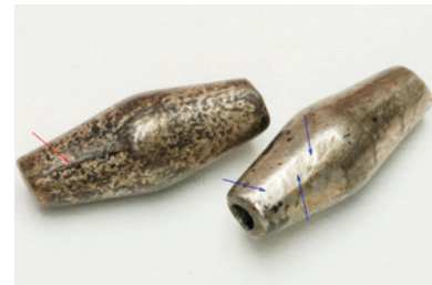
Abb. 22: Silberne langelliptische Perlen (MVF X1c 5107). Längsnaht (Pfeil, rot) und durch Feilen retuschierte (abgeflachte) Naht (Pfeile, blau). © SMB, MVF Foto: Hermann Born
