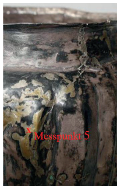
Abb. 10: Silberner Rippenbecher (MVF Xlc 5104). Lötstelle mit Messpunkt 5, Durchmesser 0,1 mm. © SMB, RF Foto: Sabine Schwerdtfeger
