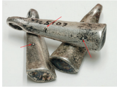
Abb. 18: Silberne Anhänger (MVF X1c 5107). Gussperlen (sog. Spratzen) vom Abkühlungsprozess nach dem Silberguss (Pfeile, vgl. Abb. 16, 17). © SMB, MVF Foto: Hermann Born
